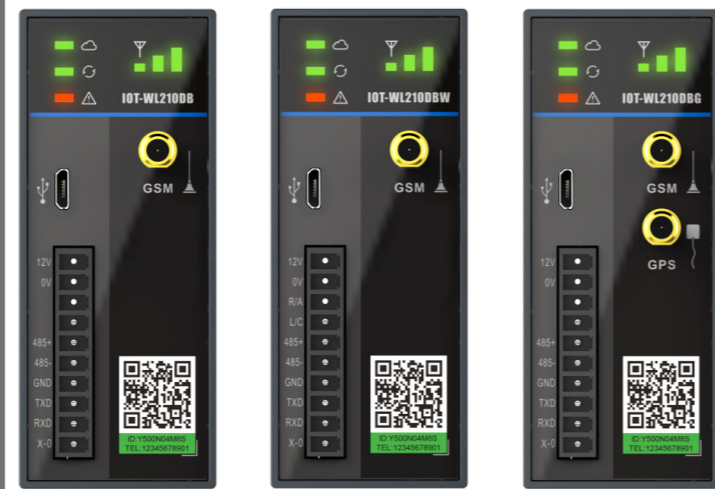
图2 端口分布示意图
