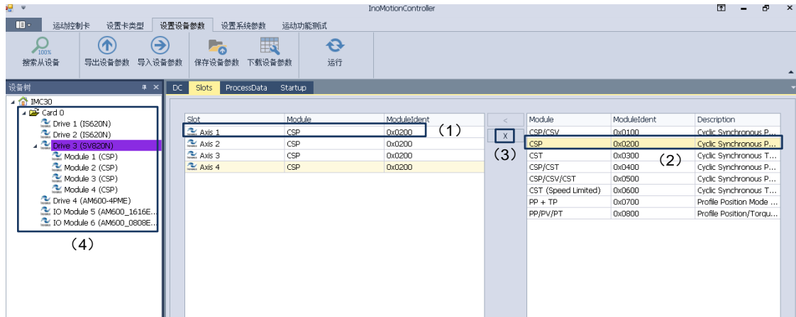
图：SV820 pdo 配置步骤 3
