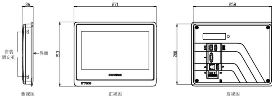
图 2-1 产品尺寸图 (单位 mm)
